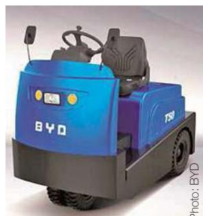
Der neue 5-t-Elektroschlepper von BYD kommt in kraftvoller, wartungsfreier 48-V-Drehstromtechnik daher.
